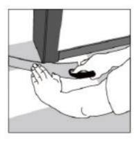
12.Door molding and skirting: lay a board (with the decorative side down) next to the door molding and as shown in the figure. Then slide the floorboard under molding. Puerta y zócalo: colocar una tabla (con el lado decorativo hacia abajo) junto a la moldura de la puerta, como se muestra en la figura. Luego, deslice el piso bajo la puerta.
